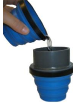
10Cells setindeki 50 mikron filterden süzün
