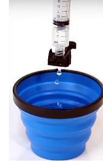
10Cells setindeki 10 mikron filtreden süzün
