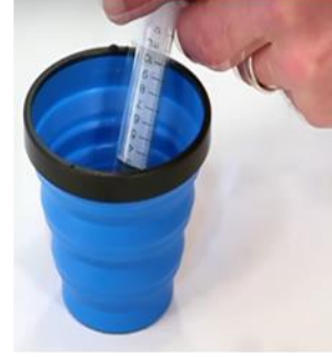
Süzülen sudan 10ml almak için Şırıngayı kullanın
