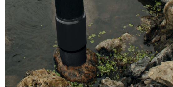
BenthoTorch, alg sınıflarını ve bunların bir taş yüzey üzerindeki konsantrasyonlarını ölçmek için kullanılır.
