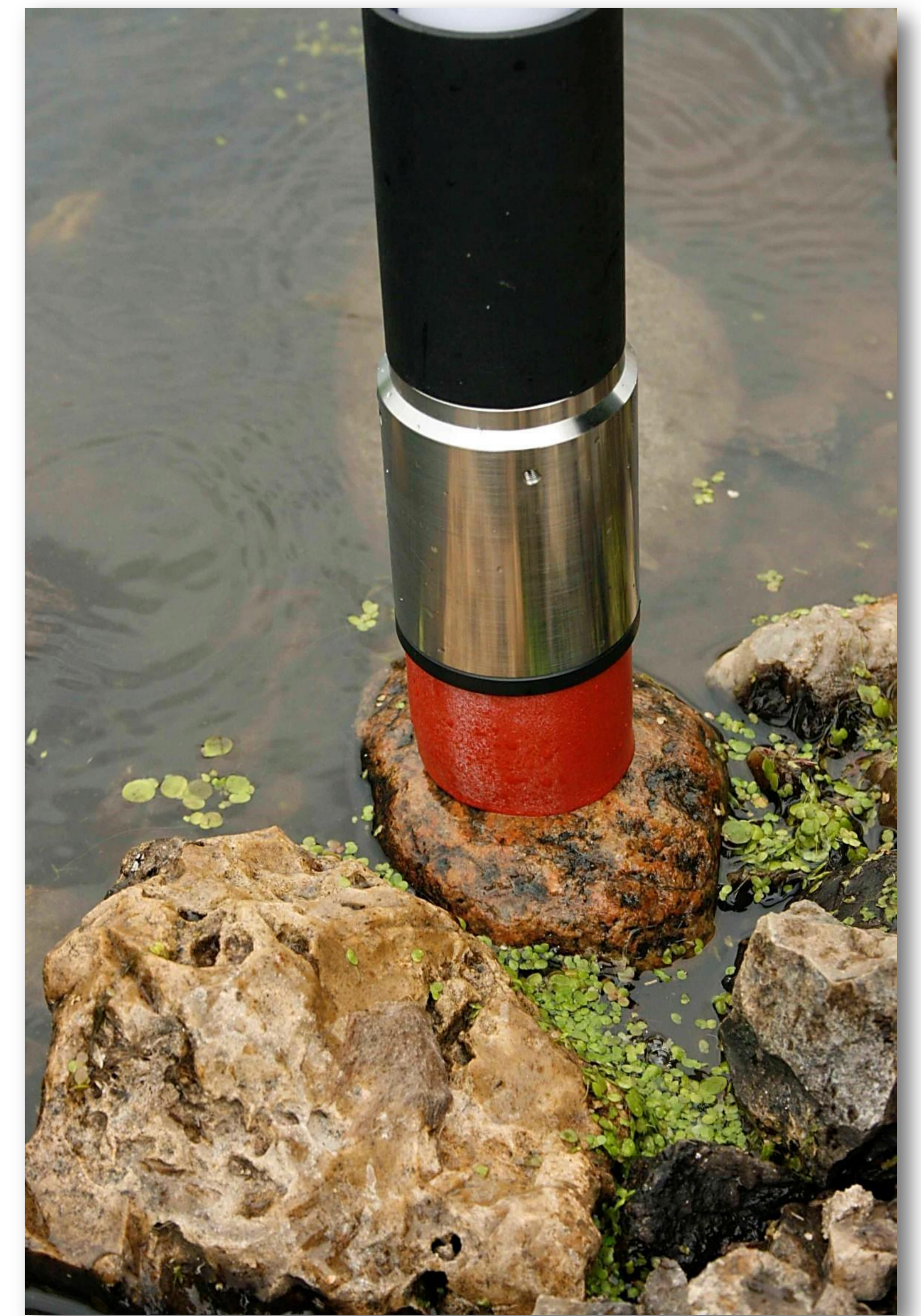
BenthoTorch: Farklı yüzeylerde bentik alglerin ölçümü için
