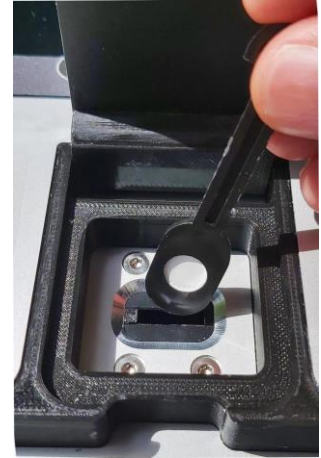
Numune suyunu içeren filtre şeridi sadece birkaç saniye içinde analiz edilir
